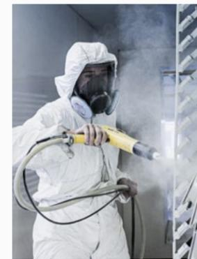
Alle Aluminiumkomponenten lackieren wir in der eigenen Pulverbeschichtungsanlage mit Fassadenfarben mit UV-Stabilität gemäß GSB- und Qualicoat-Standards. Standardmäßig lackieren wir in RAL-Farben, auf Wunsch auch in weiteren Spezialfarben.
